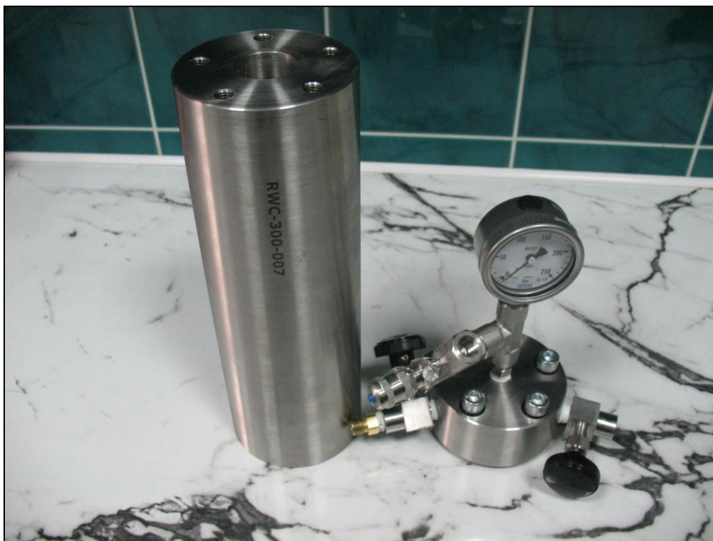
Fot. 3. Autoklaw do przechowywania próbek kamieni cementowych w środowisku CO 2 .
