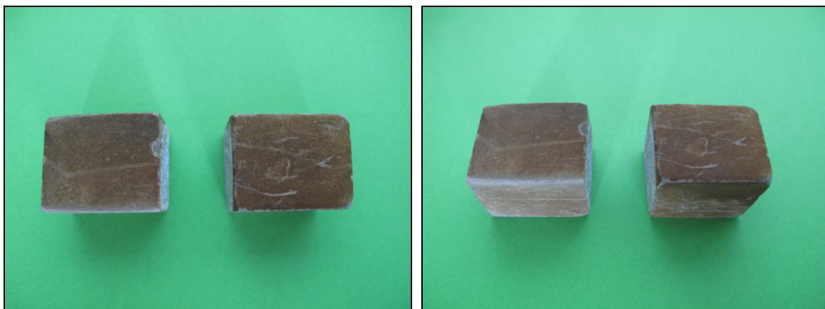
Fot. 5. Próbki kamienia cementowego Nosówka 7 wyjęte z autoklawu po 27 miesiącach deponowania w warunkach wysokiego ciśnienia (20 MPa), temperatury 80°C i w środowisku CO 2 .
