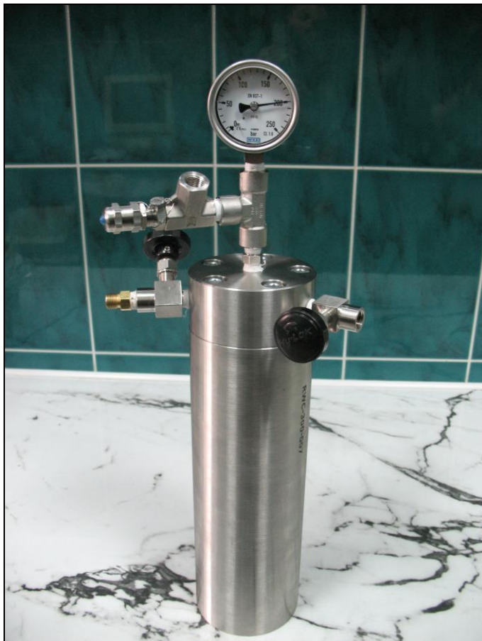
Fot.1. Autoklaw z próbkami kamieni cementowych nasyconych CO 2 pod ciśnieniem 200 bar.
